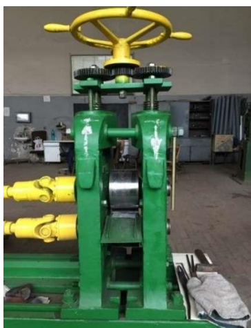
Figura 2.5. Aspectul laminorului duo Ø180x200mm.
