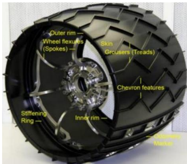
Figura 1.10. Roată Curiosity din aliaj de aluminiu 7075-T7351 [125].
