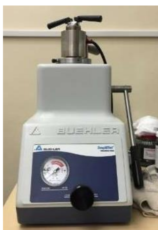
Figura 2.10. Presă de înglobare BUEHLER Simplimet.
