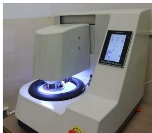
Figura 2.11. Mașină de șlefuit și lustruit Metkon DIGIPREP Accura.
