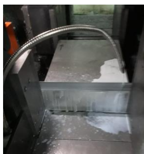
Figura 2.3. Debitarea unei probe pe fierăstrăul de probe.
