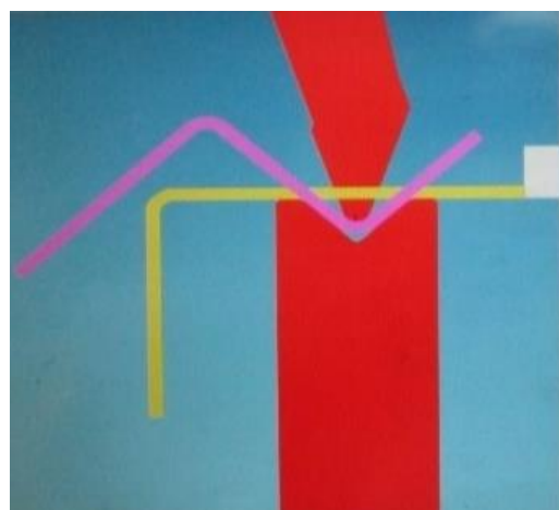
Fig. 7.3. Secvențe din simularea operației de îndoire a pieselor A'1,5.2.2 [C01, P05]
