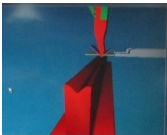
Fig. 7.3. Secvențe din simularea operației de îndoire a pieselor A'1,5.2.2 [C01, P05]
